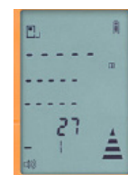
Laserstrålen er 27 mm over referencehøjden (flyt modtager opad).
